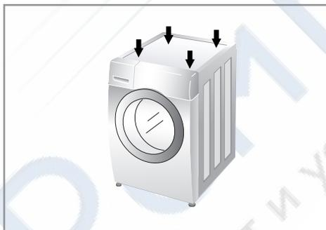
1. Надлежащее выравнивание стиральной машины по уровню предотвращает излишний шум и вибрацию. Устанавливайте устройство на твердой и ровной поверхности, предпочтительно в углу помещения.
