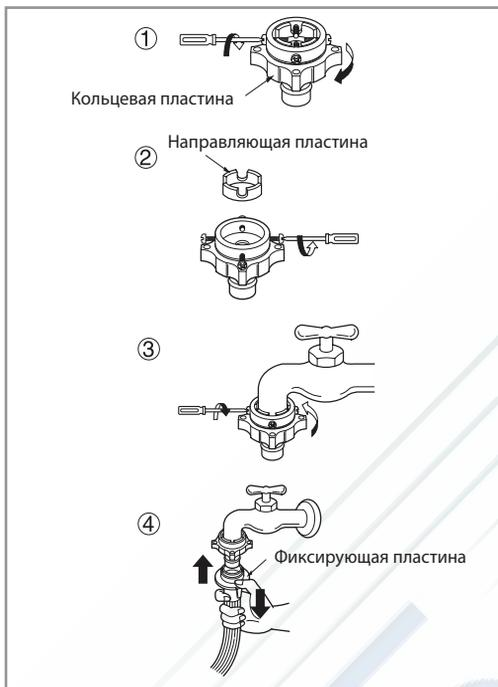
1. Открутите кольцевую пластину адаптера и 4 винта, фиксирующие адаптер.
