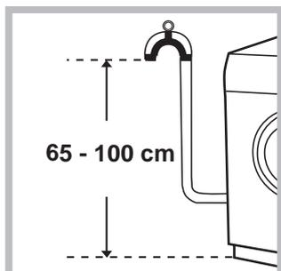
Повесьте загнутый конец сливного шланга на край раковины, ванны, или поместите в специальный вывод канализации. Шланг не должен перегибаться. Верхняя точка сливного шланга должна находиться на высоте 65-100 см от пола. Расположение сливного шланга должно обеспечивать разрыв струи при сливе (конец шланга не должен быть опущен в воду). В случае крепления на край ванной или раковины, шланг вешается с помощью направляющей (входит в комплект поставки), которая крепится к крану (рис.).
