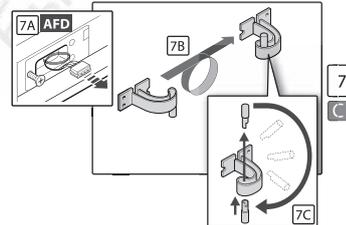
С) достаньте цилиндрическую направляющую из шарнира и установите его в его нижней части.
