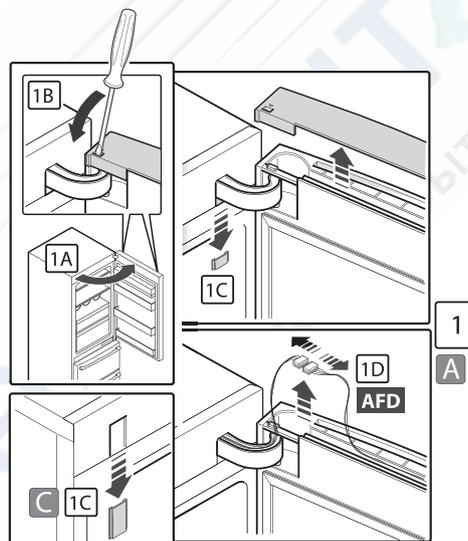
**2.** А) снимите болты, которые крепят переднюю панель, расположенную наверху холодильника;
