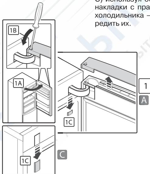
**2.** А) снимите два болта, которые крепят переднюю панель, расположенную наверху холодильника;
