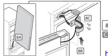
С) подключите разъем, идущий от дисплея, установите шарнир с левой стороны и закрепите его с помощью отвертки.
