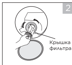
Откройте крышку фильтра, повернув против часовой стрелки
