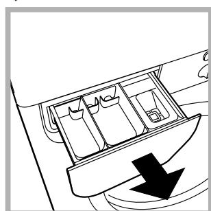
Выньте распределитель, приподняв и потянув его на себя (см. рис.), и промойте под струей воды.
