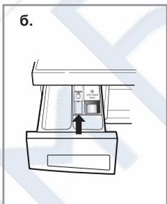
1. Нажав на стопорную защелку, извлеките выдвижной ящик из стиральной машины.
