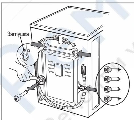
1. С помощью гаечного ключа, входящего в комплект стиральной машины, отвинтите четыре транспортировочных болта.
