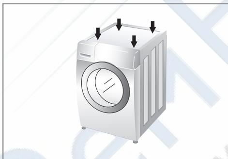
1. Для предотвращения вибрации и чрезмерного шума необходимо придать стиральной машине строго горизонтальное положение. Стиральную машину следует устанавливать на твердом, ровном полу.
