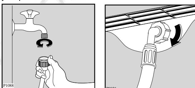
Другой конец наливного шланга, подключающийся к машине, может быть повернут в любом направлении. Ослабьте гайку, поверните шланг и вновь затяните гайку, проверив отсутствие течи воды. Наливной шланг нельзя вытягивать. Если он слишком
